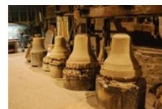
Pour faire une cloche il faut construire un moule qui correspond à l'empreinte en creux de la future cloche et que l'on va remplir avec du métal en fusion. Pour résister à cette température, le matériau de moulage est composé d'argile, de crottin de cheval et de poils de chèvre.
